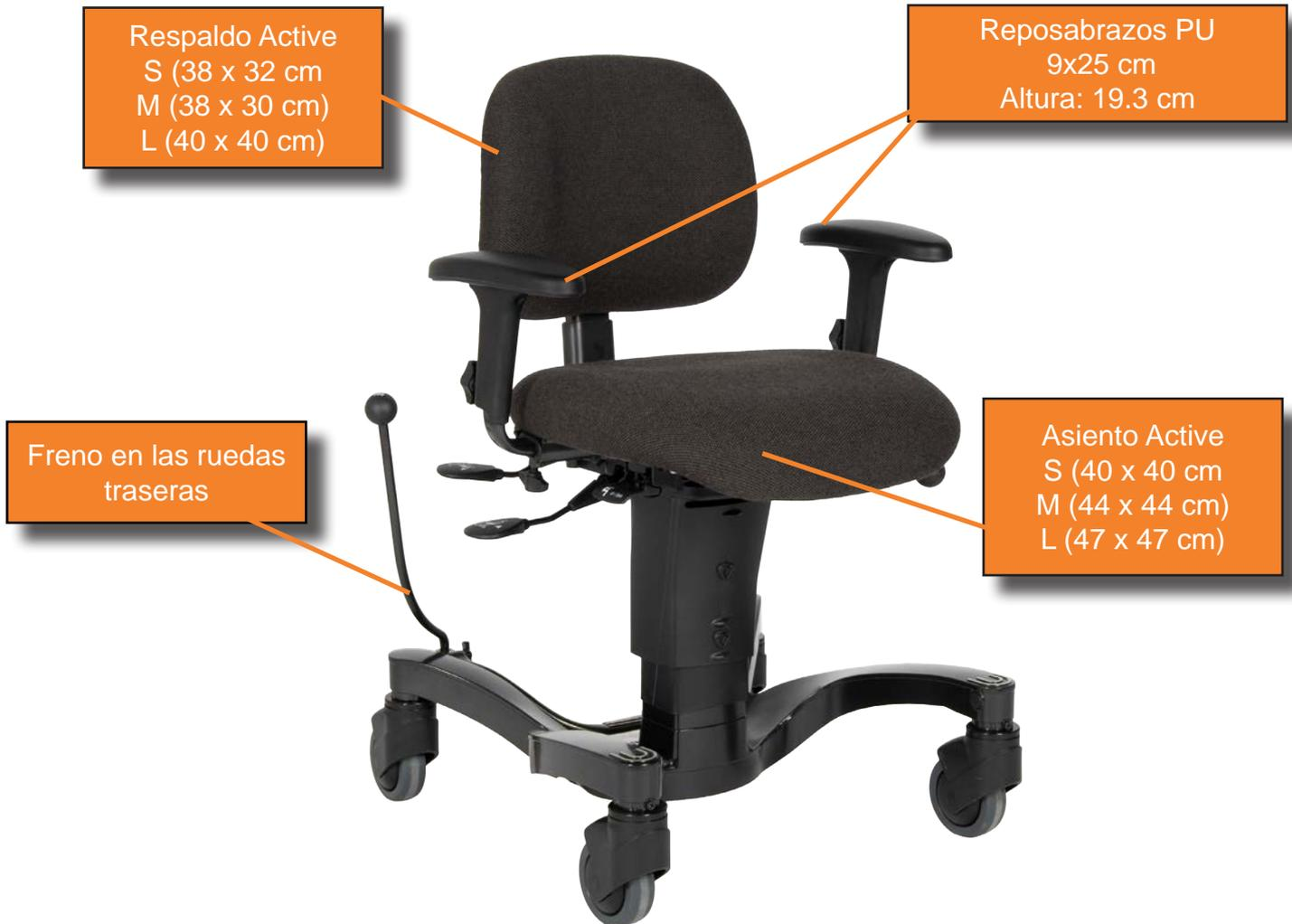
**Asiento giratorio:** con las ruedas frenadas, se puede activar una palanca bajo el asiento y girar el asiento 90° izquierda y 90° dcha.
